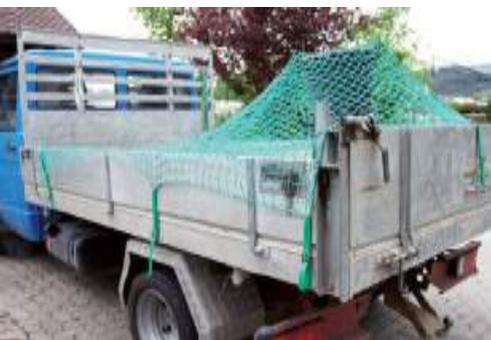
Les filets en PP haute résistance pour l'arrimage de sécurité et le recouvrement sont appropriés pour la protection contre les chutes d'objets ou de marchandise volatile. Le filet empêche votre cargaison légère de se répandre hors de la surface de chargement et maintient les matériaux de construction, le bois ou les déchets végétaux. Ils sont adaptés pour les conteneurs, les bennes basculantes, les camions et les fourgonnettes.
