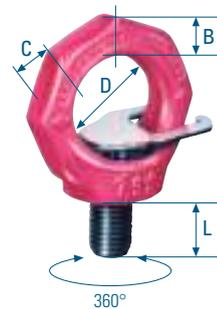
Anneau de levage rotatif à 360°, s'oriente dans la direction de la traction, ainsi la traction se fait toujours dans le plan de l'anneau. Avec roulement à billes. Vis hexagonale imperdable avec sécurité utilisable plusieurs fois. Pour un montage facile, il suffit d'employer la clé frein à six pans livrée.
