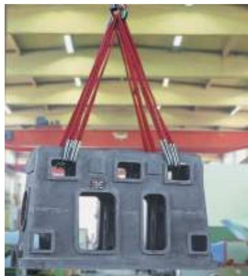
Les nouvelles **SupraPlus** sont jusqu'à 20 % moins épaisses que les modèles précédents. Elles procurent l'avantage de pouvoir être utilisées avec des petits crochets de levage sans être tordues et ainsi d'éviter les pertes de capacité accidentelles.
