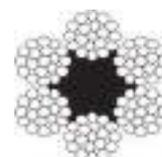
Câble standard en âme métallique, pour haubans et applications diverses (treuils, portes basculantes, câble d'entraînement et de levage, etc.).
